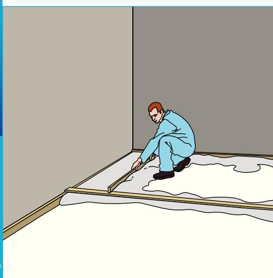
KNAUF AQUAPANEL® tökməsini döyəcləyib sıxlaşdırmaq lazımdır. Bunun üçün üstdən örtük plitələri qoyulur ki, bu da yükün bərabər şəkildə paylanmasına xidmət edir. Tökməni əlverişli üsulla (60 mm-ə qədər qalınlığı olan təbəqə: üzlənmiş plitələrin bütün səthi boyu gedilməlidir; 60-dan 200 mm-ə qədər: əl çəkici və ya elektrik vibratorunun köməyi ilə) döyəcləyib bərkidin.
